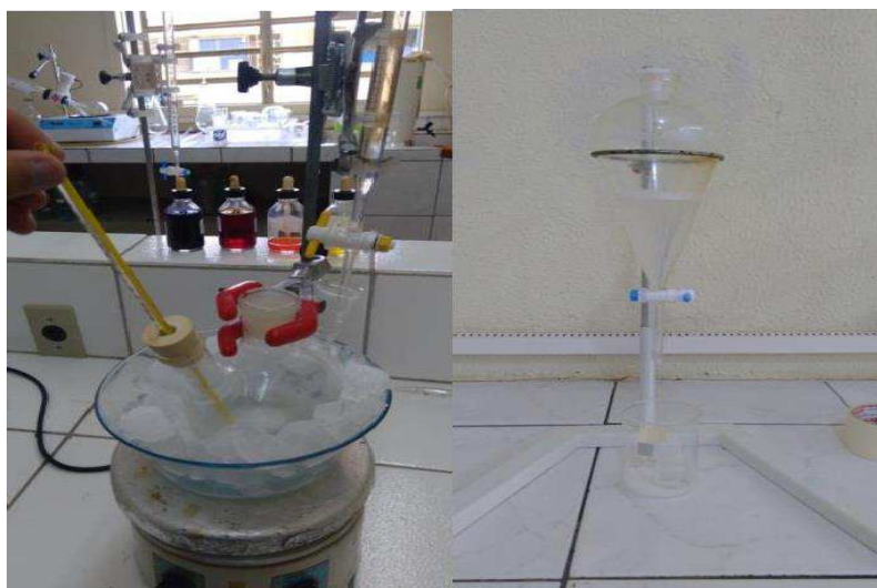
Figura 10. Processo de produção e purificação do biolubrificante etílico de óleo de pinhão-manso.
