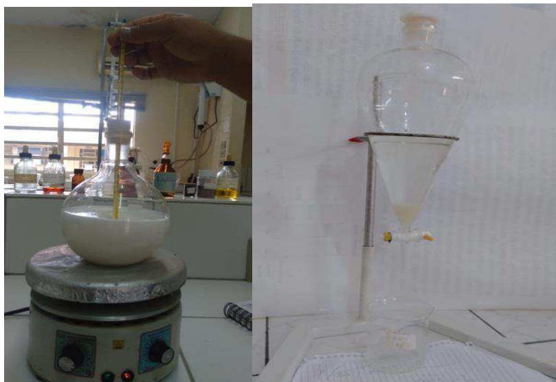
Figura 8. Processo de produção do biodiesel metílico de óleo de Pinhão-Manso:
