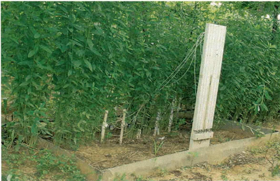
Fig. 3.5. Detalhes de instalação dos tensiômetros de mercúrio nos lisímetros de drenagem, Petrolina – PE.
