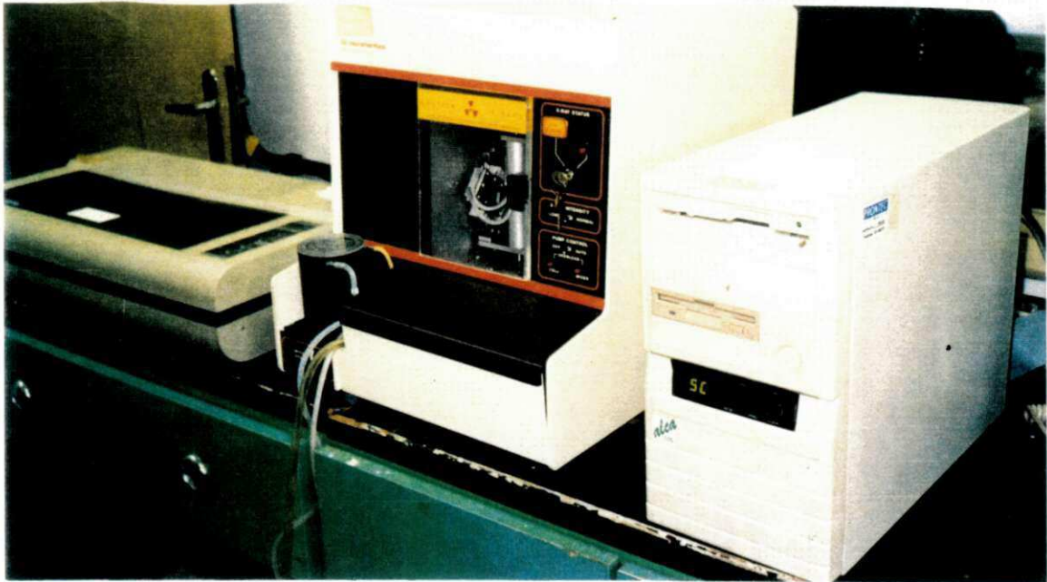
Fig. 3.11 - Distribuição granulométrica em aparelho sedigraph 5100 V3.03
