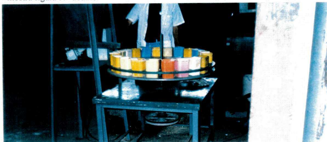
Fig. 3.9 – Técnica de homogeneização / com homogeneizador rotativo.
