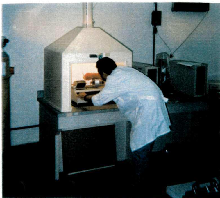
Fig. 3.12 – Aparelho analisador termogravimétrico, modelo 951 da Du Pont.
