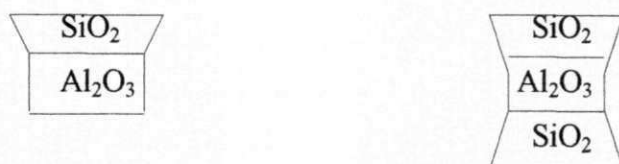
Fig. 2.0 - Representação esquemática da estrutura cristalina da caulinita e montmorilonita.
