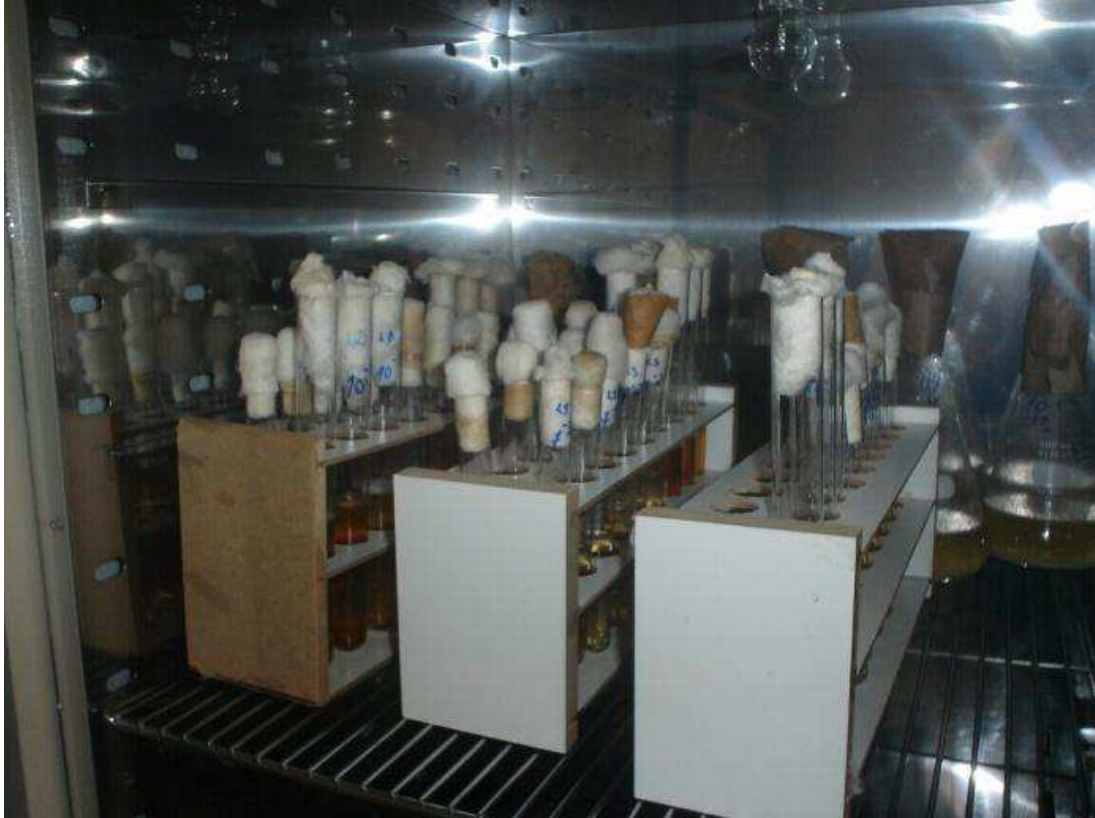
Figura 7 Incubação a 35 \pm 2^\circ\text{C} por 24 horas em caldo Lauril inoculado com amostra para detecção de coliformes totais
