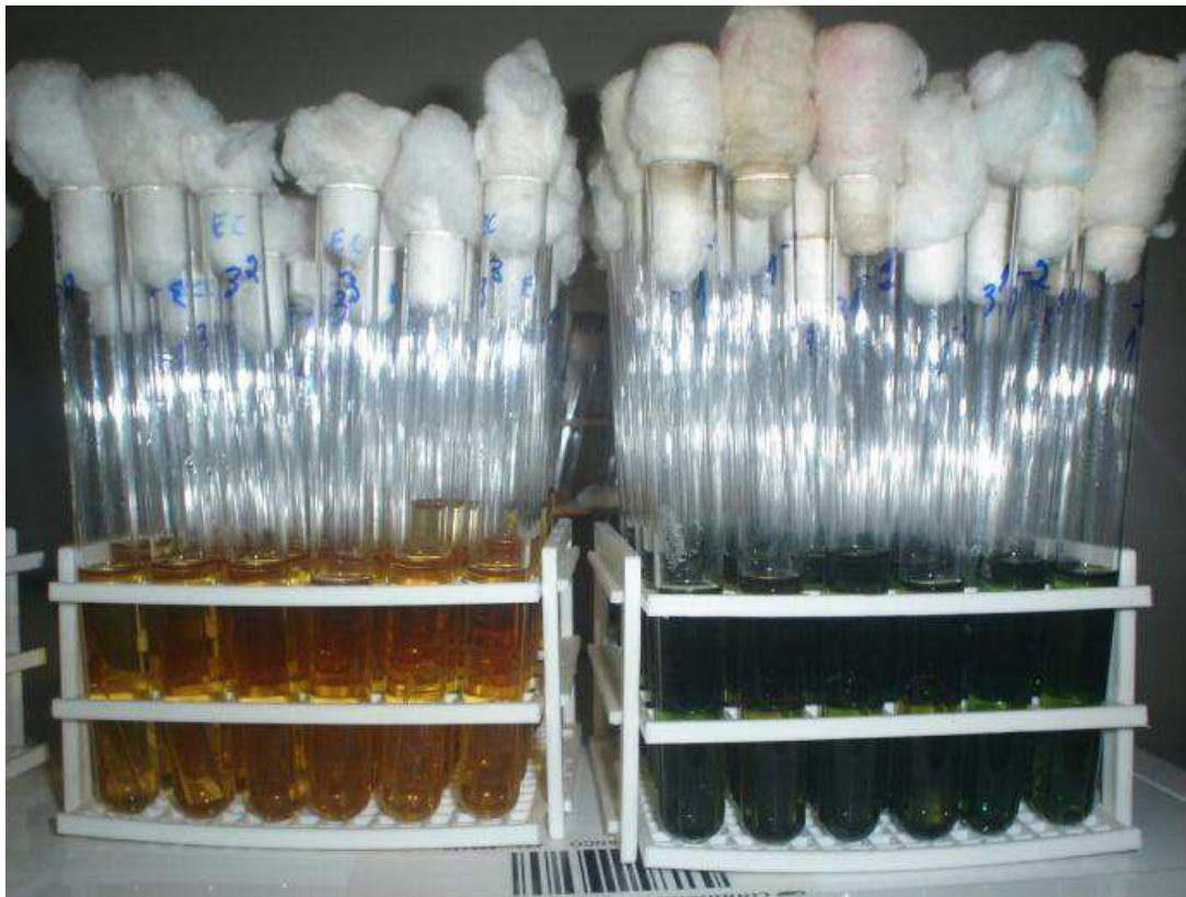
Figura 9 Utilização de CVB e CEC em tubos de ensaio com tubos Duran invertido como método confirmatório para coliformes totais
