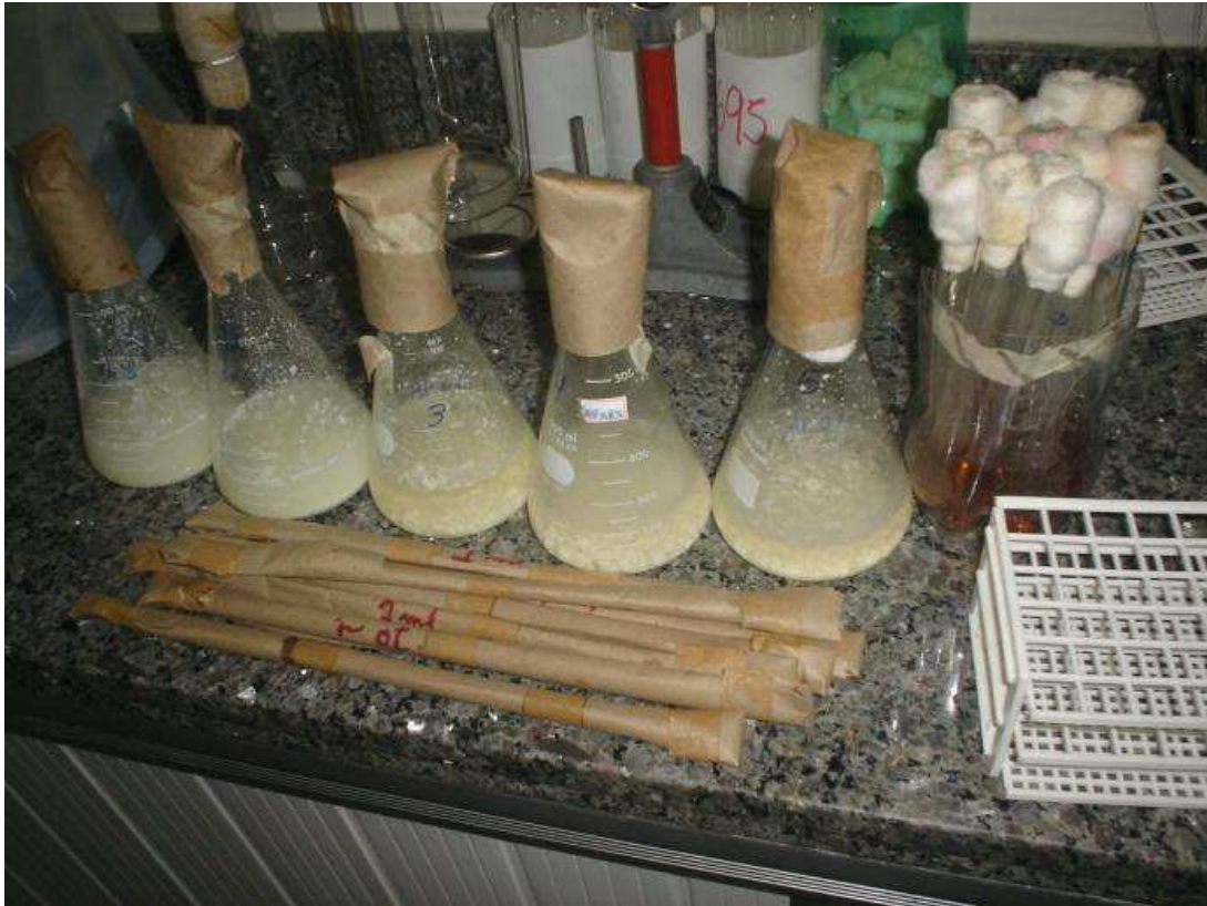
Figura 6 Amostras homogeneizadas em AP prontas para ser transferidas para tubos de ensaio com contendo Caldo Lauril e tubo Durhan invertido no seu interior
