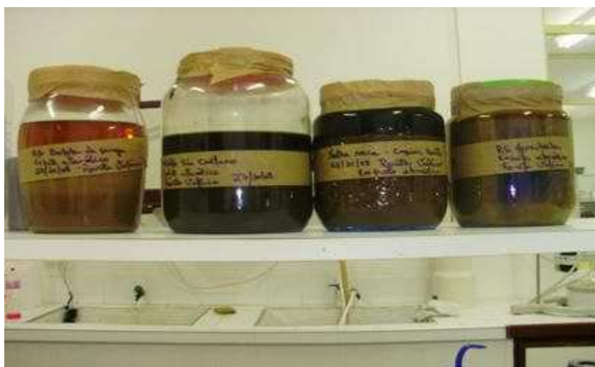
FIGURA 5: Extração Etanólica para elaboração de extratos de Jurubeba, Capim Santo, Batata de Purga e Melão de São Caetano. Fonte: SOUSA, R. V. R., LPPN/URCA – 2008.
