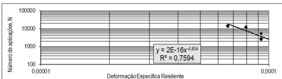
Figura 39 - Curva de Wholer: número de aplicações versus deformação específica resiliente
