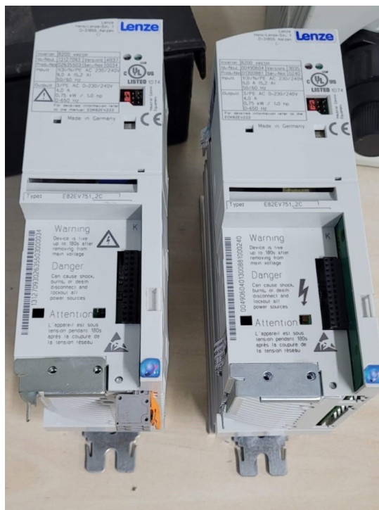
Figura 9 – Inversor de frequência utilizado no Raio-x.
