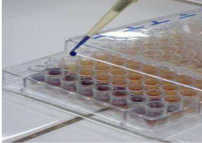
Figura 7 Adição da resazurina em cada poço. Fonte: SANTOS, F.O., LPPN /URCA, (2009).
