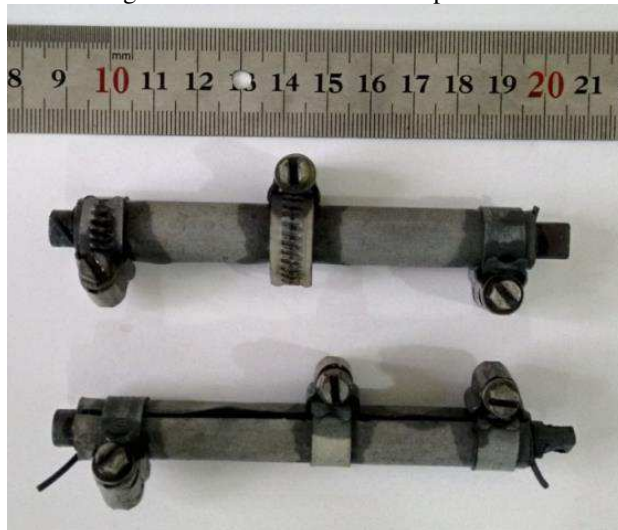
Figura 30 - Fotografia dos fusos com molas após tratamento térmico.
