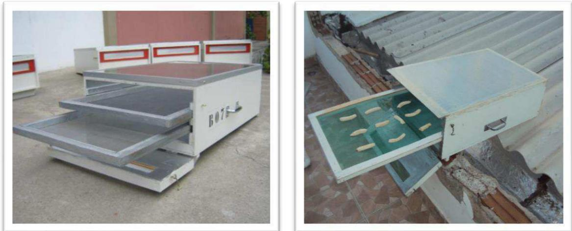
**Fonte: Secador solar de exposição direta construído por Nunes et al. (2013).**
