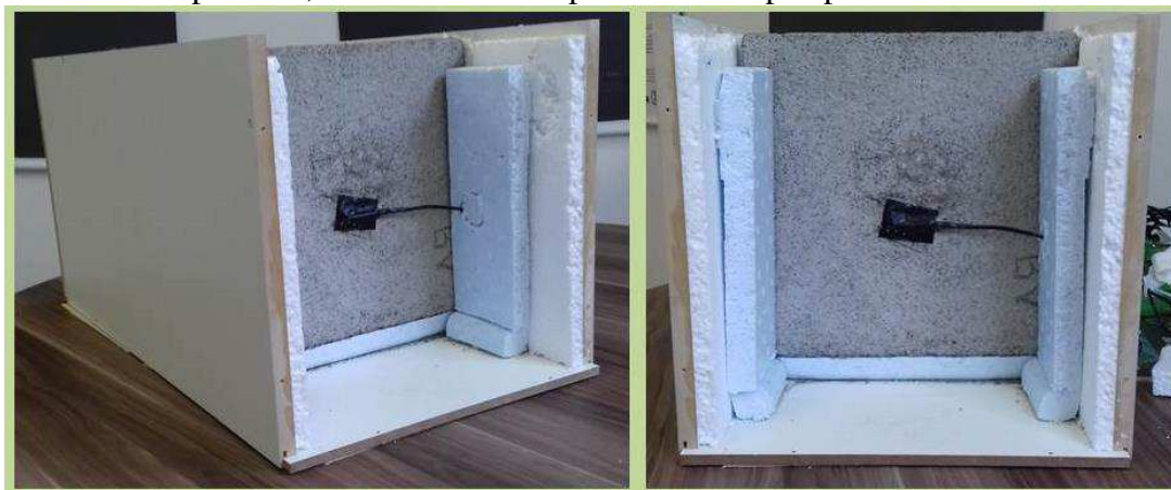
Figura 18 - Câmara de fluxo térmico com a placa de argamassa e sensores de medição e temperatura, sem silicone e isopor. Vista em perspectiva e frontal
