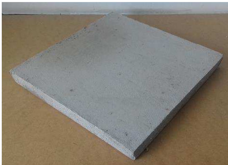
Figura 16- Amostra para ensaio de condutividade térmica.
