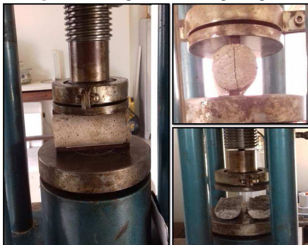
Figura 31- rompimento de corpo de prova.
