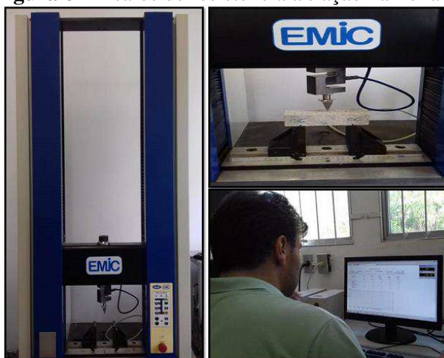
Figura 8- Ensaio de resistência á tração na flexão.
