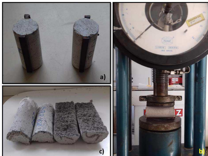
Figura 11 - Ensaio de resistência à compressão diametral. a) corpo com talisca de madeiras; b) corpo de prova submetido a carregamento; c) corpo de prova rompido no plano longitudinal.
