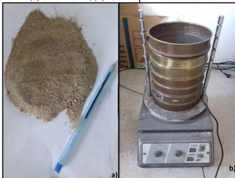
Figura 5 – (a) areia natural; (b) série de peneiras instalada em mesa vibratória.
