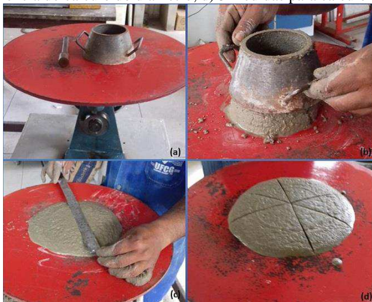
Figura 6 - Desenvolvimento dos ensaios de consistência. (a) equipamentos; b) desmoldagem; c) conferência do cálculo do diâmetro; d) 3 medidas para cálculo da média.
