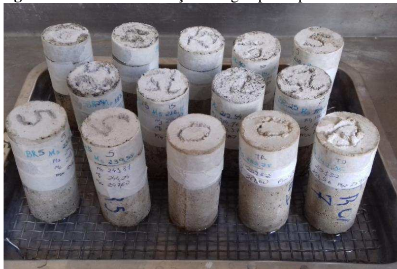
Figura 7- Ensaio de absorção de água por capilaridade.
