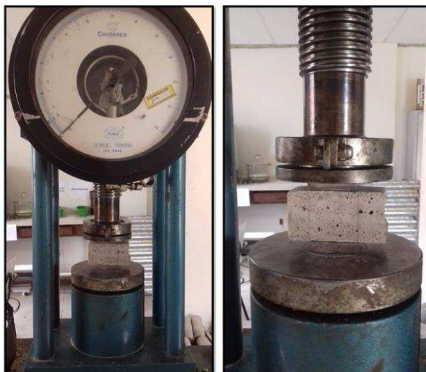
Figura 9- Ensaio de resistência à compressão.
