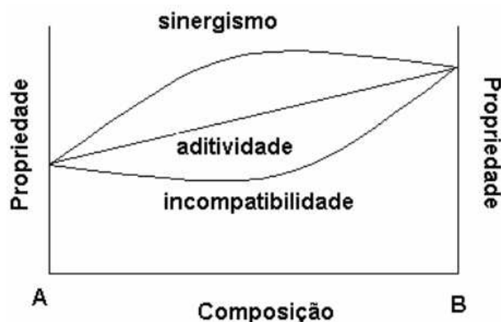
Figura 2 – Gráfico demonstrativo da classificação de compatibilidade de materiais em relação às propriedades obtidas (Roeder et al. , 2005)
