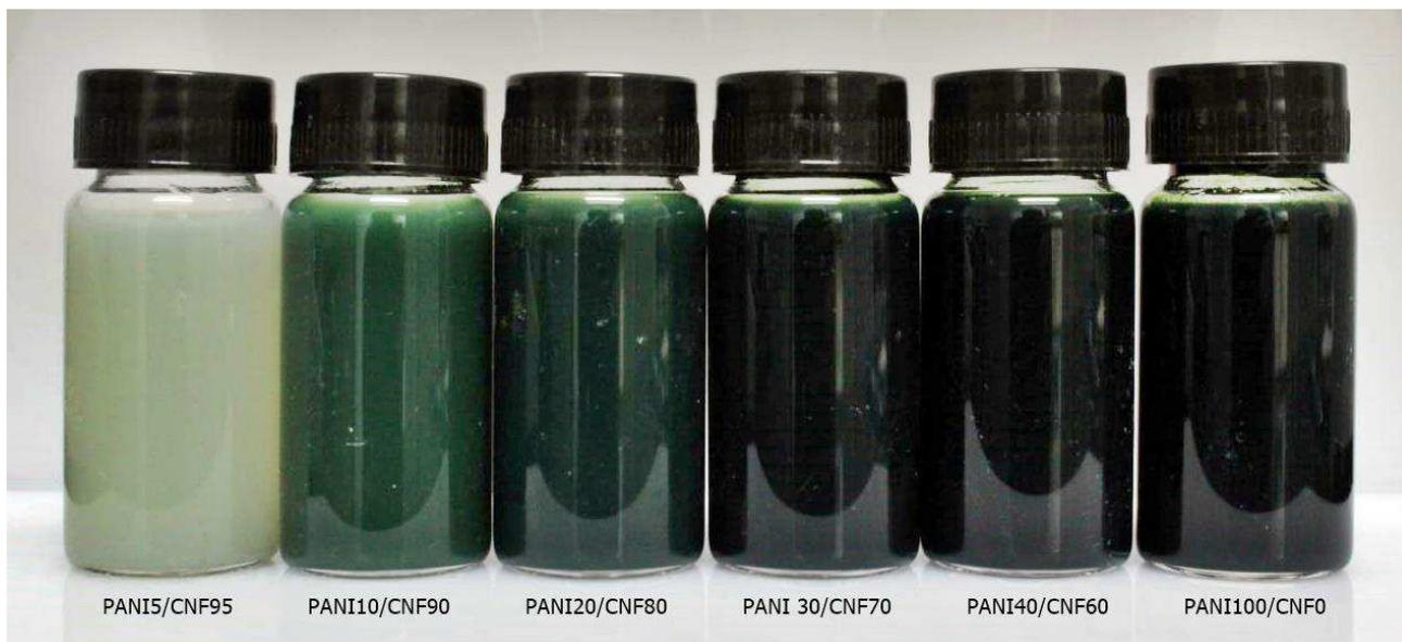
Figura 9 - Dispersões de PANI/CNF em várias concentrações após a polimerização (C=10mg/ml) após 1 hora.
