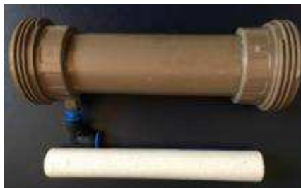
Figura 29 - Módulo da membrana cerâmica em PVC.
