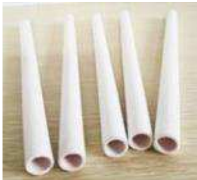
Figura 26 – Membranas cerâmicas confeccionadas.
