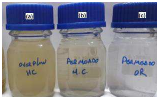
Figura 52 – Amostras do overflow do SHC (a), permeado do SMC (b) e permeado da membrana de OI (c).
