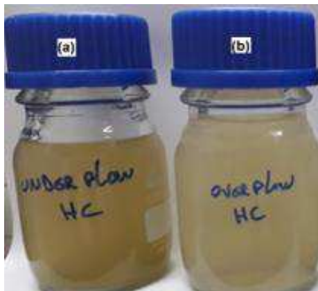
Figura 36 – Registro das amostra da água A 1 pós tratamento pelo SHC: (a) Underflow , (b) Overflow .
