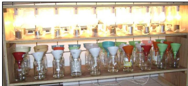
Figura 5 Extrator de Berlese-Tullgren, modificado, usado para extração da mesofauna do solo.
