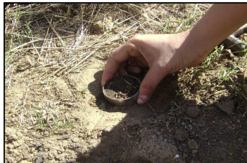
Figura 4 Cilindro metálico utilizado na coleta da mesofauna solo + serapilheira (março/2008)
