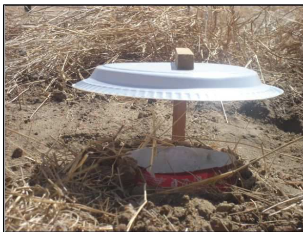
Figura 6 Armadilha do tipo Trampa de Tretzel utilizada para captura de organismos da macrofauna do solo
