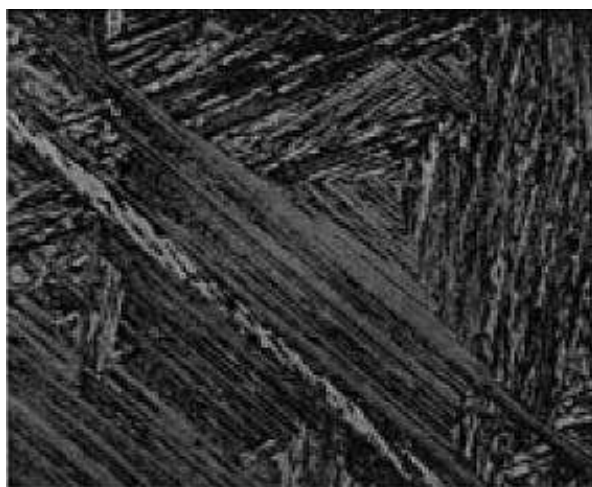
Figura 11 - Microestrutura martensítica em forma de ripas. Ampliação 175X (ASM, 2009).
