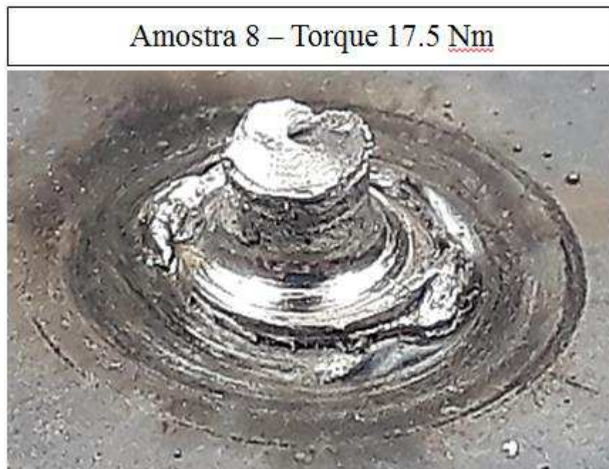
Figura 39 – Imagens das fraturas obtidas após ensaio de torque referente a cada amostra
