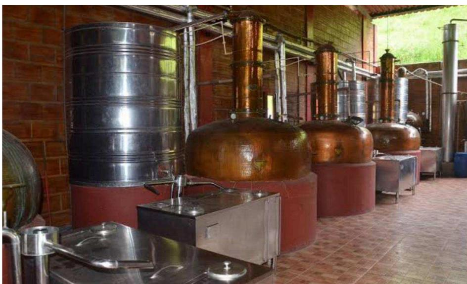
**Imagem 1: alambique de Cobre usado no processo da produção de cachaça, Destino da Paraíba, 2019.**
