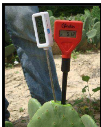
Figura 3: Detalhe da determinação do pH e temperatura do cladódio da palma forrageira.em Assunção – PB,(SILVA, S.G 2009)
