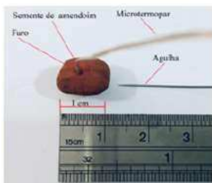
Figura 12 – Preparação da semente para colocação do termopar
