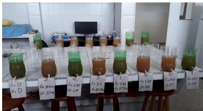
Figura 3 – Ensaio de tratamento das amostras de 1 L de água, obtidas no processo de lavagem de automóveis.
