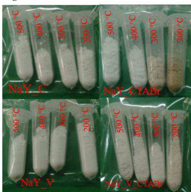
Figura 17 – Estabilidade térmica das zeólitas.
