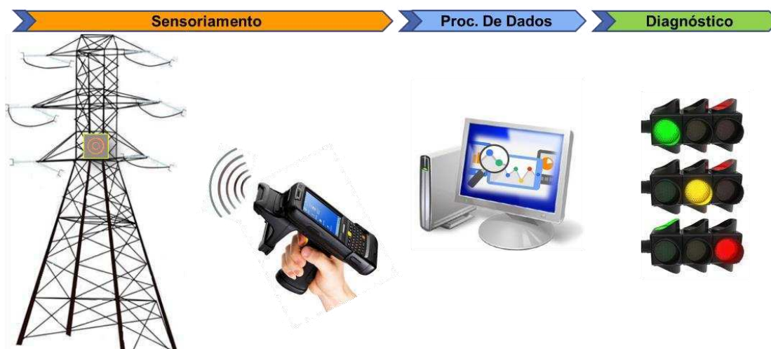
Figura 1 - Sistema RFID para identificação de poluição em torres de alta tensão
