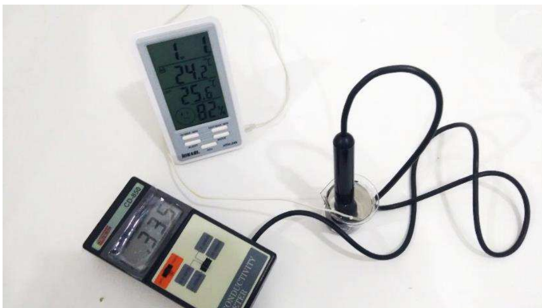
Figura 15 – Medição de condutividade e temperatura da solução da poluição.
