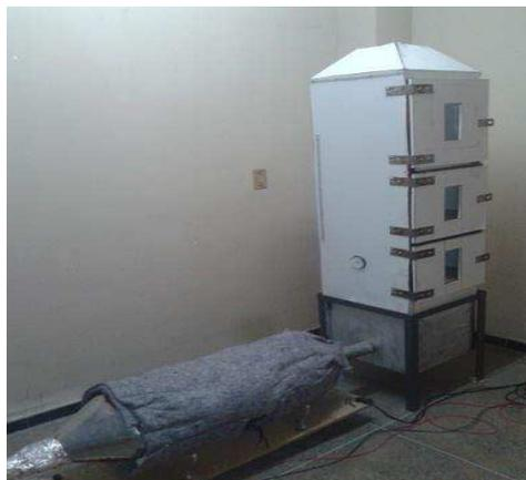
Figura 3.4 - Secador convectivo de leito fixo utilizado nos experimentos.
