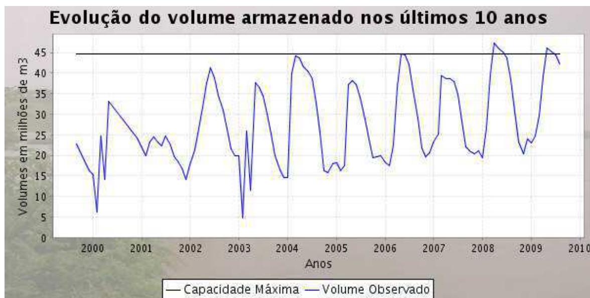
Figura 4.35 – Representação gráfica do volume armazenado nos últimos 10 anos do açude de São Gonçalo-PB. Fonte: AESA
