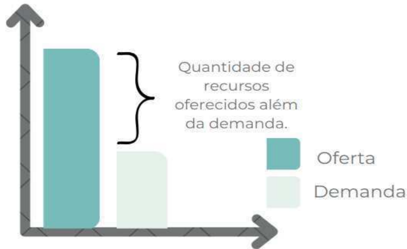
Figura 2.1: Representação gráfica da acurácia de superprovisionamento em um instante específico. As barras de cor mais escura e mais clara ilustram a oferta e a demanda de recursos, respectivamente. A seta curva indica a quantidade de recursos oferecidos além da demanda, evidenciando o superprovisionamento.
