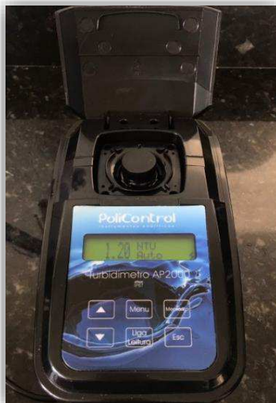
Figura 3.11 – Turbidímetro utilizado nos ensaios para medir a turbidez das amostras.
