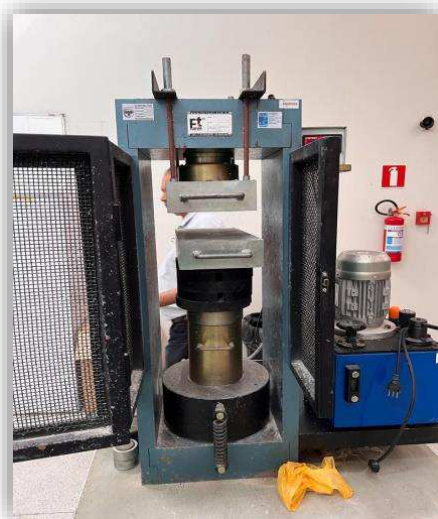
Figura 3.7 – Prensa hidráulica automática disponibilizada pelo Laboratório de Materiais do Campus Sertão da UFAL.
