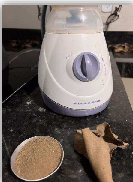
Figura 3.10 – Processador e lodo antes e depois da trituração.
