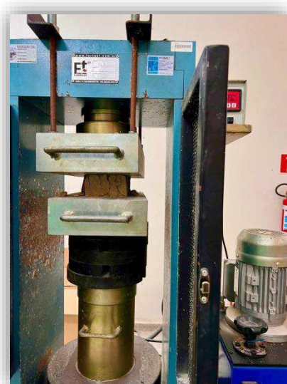
Figura 4.113 – Ensaio de resistência, realizado no LAME (UFAL), de tijolo produzido com lodo de ETA.
