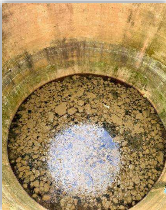
Figura 2.24 – Flocos de lodo, em decantação, que após a secagem será utilizado na composição do tijolo.
