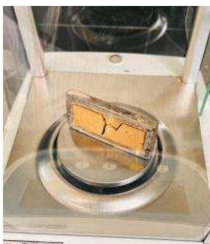
Figura 4.115 – Protótipo de tijolo experimental utilizado nas cinéticas de secagem apresentando fratura por conta de secagem a alta temperatura.
