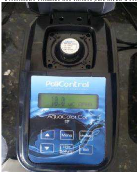
Figura 3.13 – Colorímetro utilizado nos ensaios para medir a cor das amostras.
