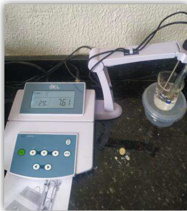
Figura 3.14 – pHmêtro portátil Bel utilizado nos ensaios para medir o pH das amostras.
