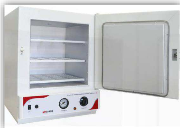
Figura 3.9 – Estufa de esterilização e secagem utilizada na secagem experimental, com capacidade de aquecimento de até 350°C.
