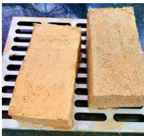
Figura 4.114 – Blocos de tijolos com diferentes concentrações de lodo preparados para os ensaios de resistência mecânica.
