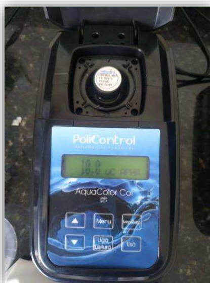
Figura 3.12 – Colorímetro utilizado nos ensaios para medir a cor das amostras.
