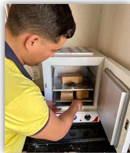
Figura 2.9 – Preparo da estufa para o processo de secagem do tipo convectivo de tijolos.
