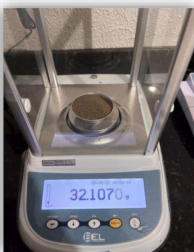
Figura 4.112 – Pesagem do lodo triturado para ser misturado à massa argilosa.
