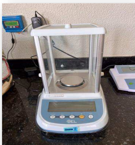
Figura 3.8 – Balança analítica utilizada na mensuração da água evaporada da secagem experimental.
