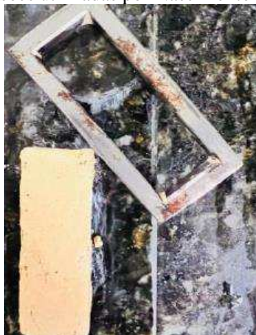
Figura 3.5 – Fôrma paralelepípedica retangular utilizada para a moldagem do tijolo semelhante as dimensões utilizadas por Nascimento (2002).
