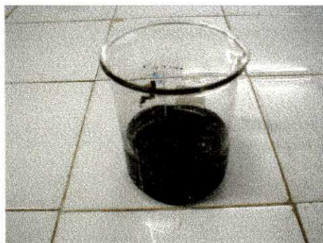
FIGURA 3.1 – Vermiculita Fina em contato com a solução de \text{AlCl}_3 0,2 M.
