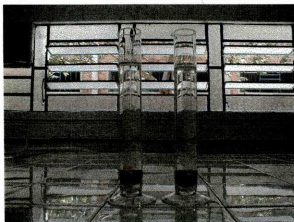
FIGURA 3.6 – Vermiculita Fina intercalada com \text{AlCl}_3 0,2 M no início do ensaio de inchamento (Tempo = 0).
