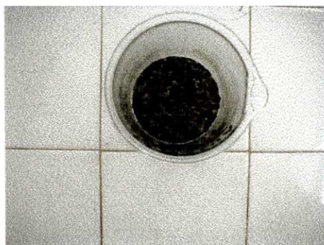
FIGURA 3.2 – Vermiculita Fina após intercalação com \text{AlCl}_3 0,2 M.
