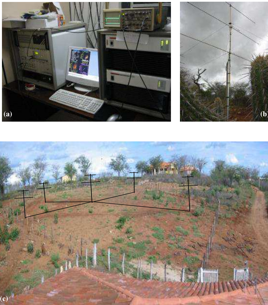
FIGURA A.1 –Radar Meteorológico – SKiYMET em São João do Cariri. (a) Equipamentos: transmissor, receptor e fonte da alimentação. (b) Antena transmissora Yagi de três elementos. (c) Sitio de localização do Radar meteorológico em São João do Cariri, com destaque para o arranjo das cinco antenas receptoras Yagi de dois elementos.
