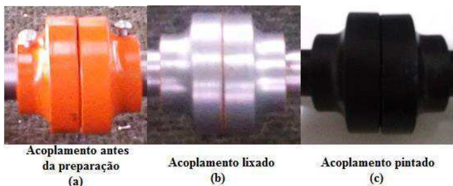
Figura 53 - Tratamento da superfície do acoplamento
