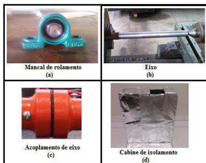
Figura 52 - Peças da bancada e cabine de isolamento
