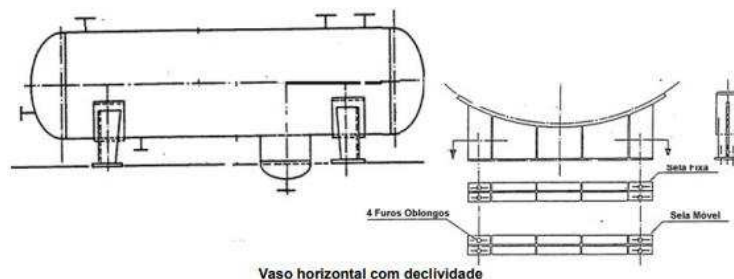
Figura 04 – Exemplo de vaso horizontal com declividade.
