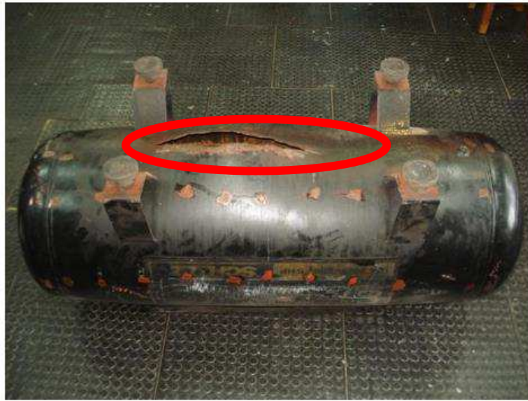
Figura 24 – Região de colapso após teste hidrostático.
