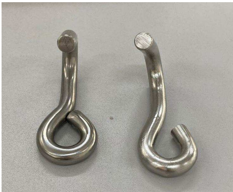
Figura 9: Posição do enrolado e gancho não conforme
