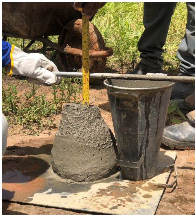
Figura 18 – Slump test do concreto.
