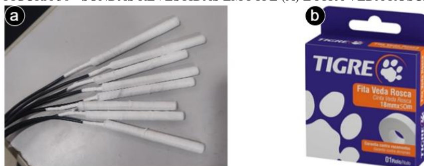
FIGURA 30 - SONDAS REVESTIDAS EM PTFE (A) E FITA VEDA ROSCA(B).
