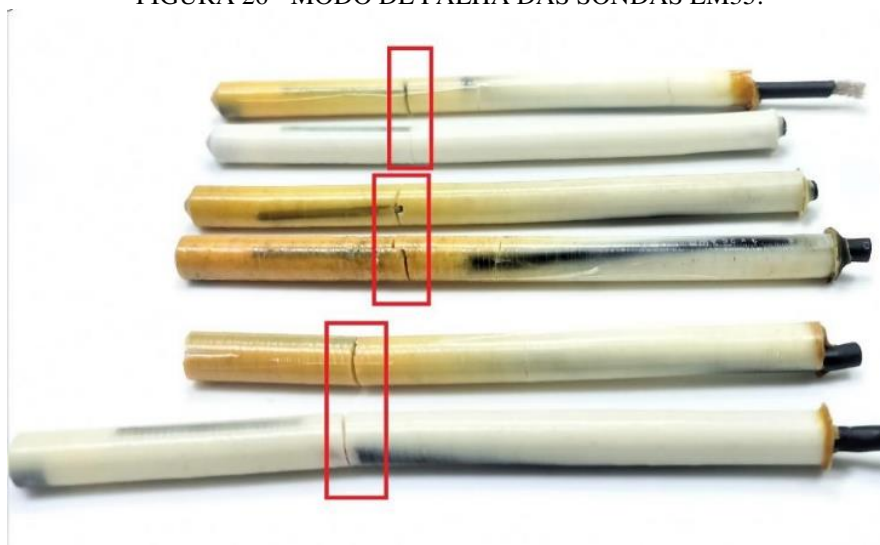
FIGURA 26 - MODO DE FALHA DAS SONDAS LM35.
