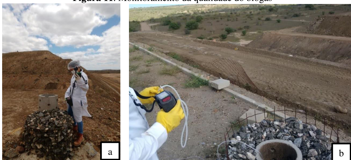
(a) medições diretas nos drenos verticais
