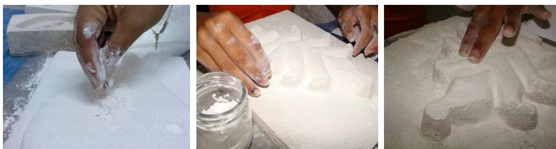
Figura 47 – Aplicação de caulim sobre os moldes de concreto celular
