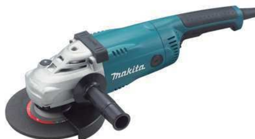
Figura 30 – Esmerilhadeira utilizada no polimento das extremidades do vidro
