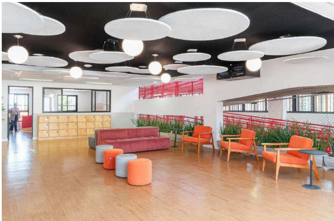
Figura 39 - Áreas de convivência com a presença de nuvens acústicas
