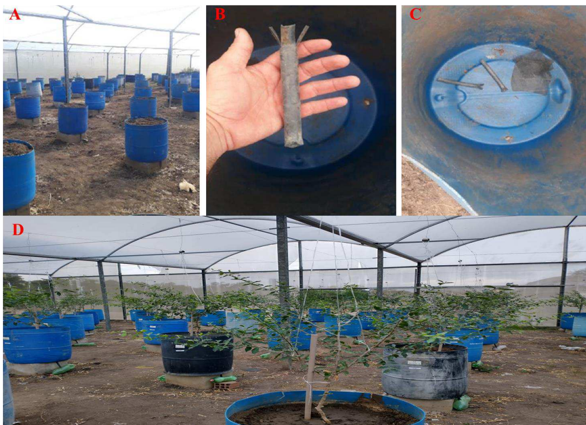
Figura 2. Visão geral do experimento, mostrando detalhe do vaso com os lisímetros preenchidos com solo (A), drenos para drenagem (B), tecido geotêxtil para evitar entupimento dos drenos (C) e recipientes plásticos para coleta de água drenada (D) durante o cultivo da aceroleira.
