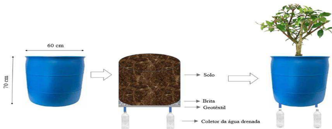
Figura 3. Ilustração do enchimento dos lisímetros de drenagem
