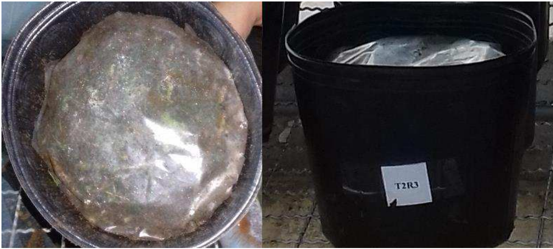
Figura 3. Simulação da solarização em vasos plásticos.
