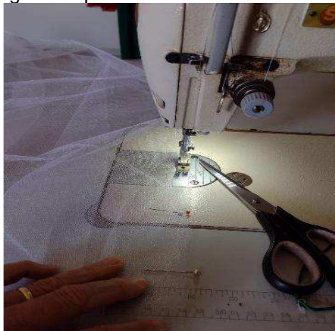
Figura 10 - Montagem de partes de um vestido em máquina de costura
