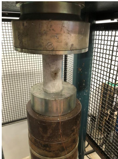
Figura 22 - Instalação do Extensômetro no corpo de prova.
