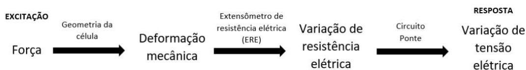
Figura 17 - Diagrama do processamento da informação.
