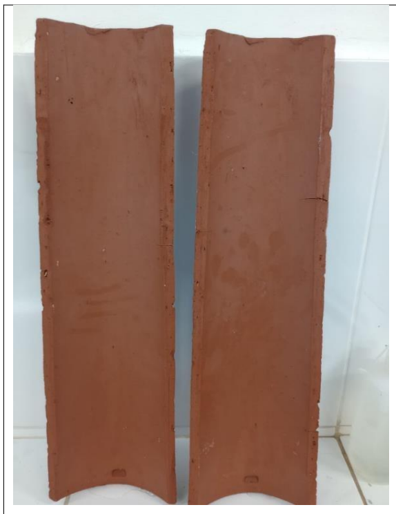
Figura 17 – Mancha de umidade nas amostras do fabricante B.
