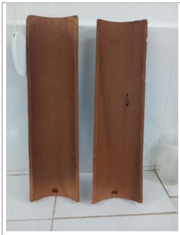
Figura 18 - Mancha de umidade nas amostras do fabricante C
