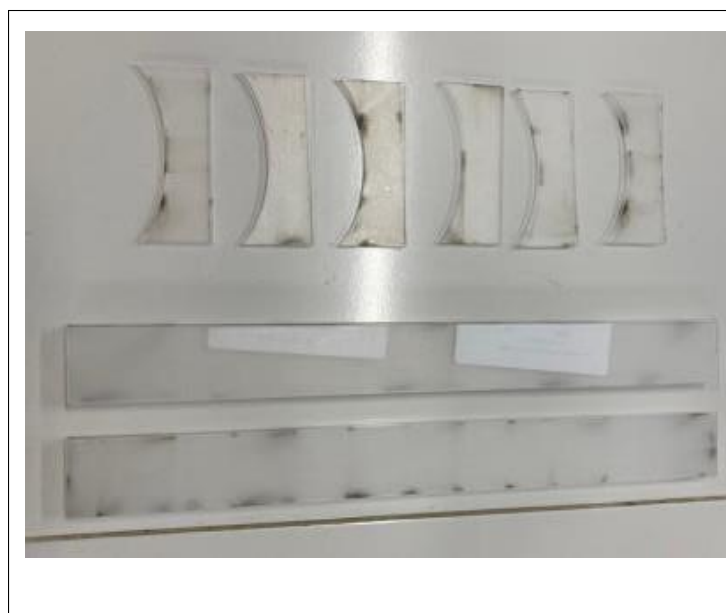
Figura 10 – moldes de acrílico confeccionados para execução do ensaio
