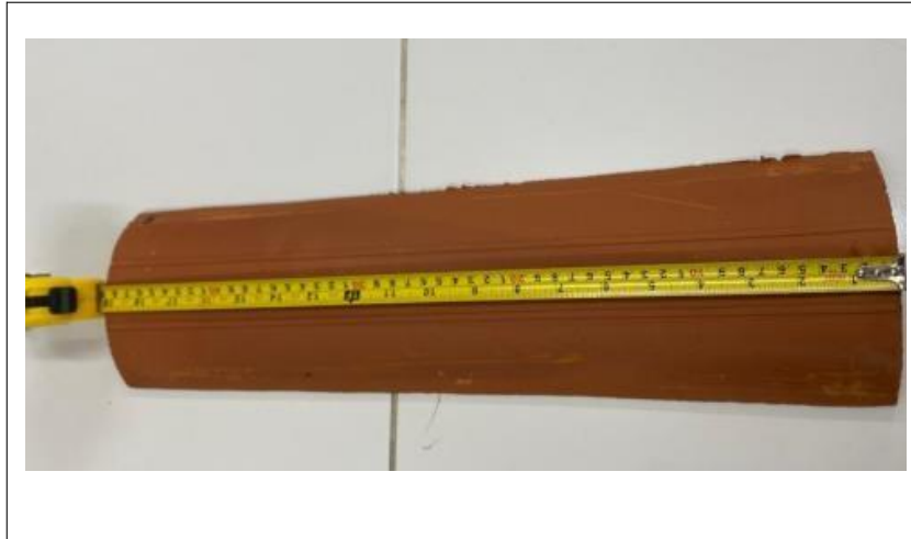
Figura 7 – Medição do comprimento efetivo das amostras.
