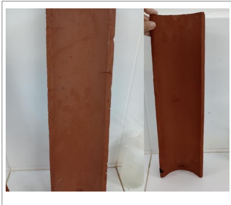
Figura 16 – Mancha de umidade nas amostras do fabricante A
