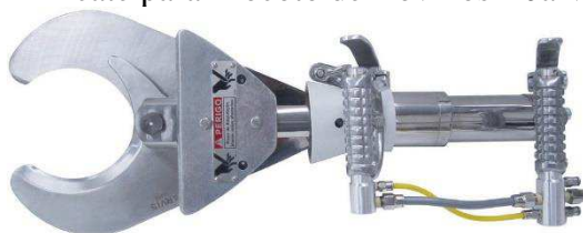
Figura 36 – Alicate para Mocotó de Bovinos – Jarvis – 30CL-1
