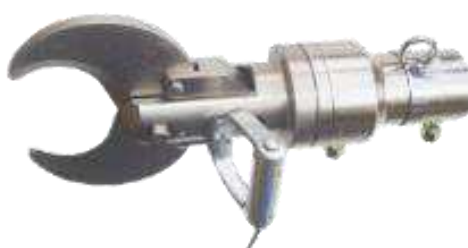
Figura 38 – Tesoura para Mocotó de Bovinos – Dal Pino – TCHM-4
