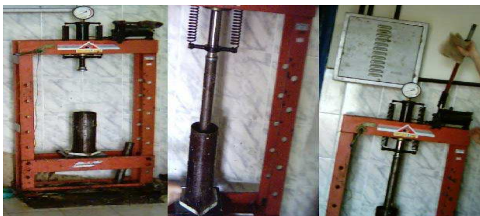
Figura 10- Prensa hidráulica manual para extração do óleo de mamona
