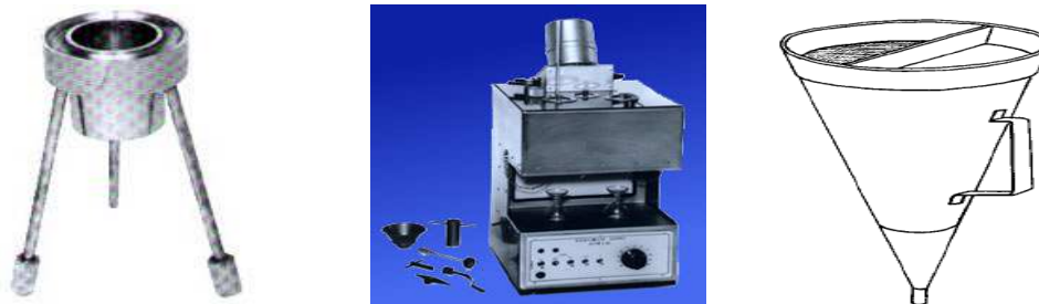
Figura 5 - Viscosímetro de Copo Ford, Viscosímetro Saybolt Universal e Viscosímetro Funil Marsh
