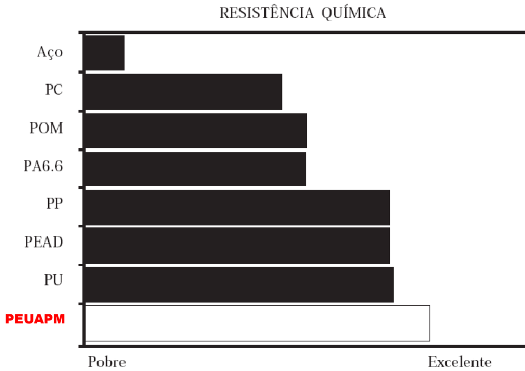
Gráfico 3.4 - Dados comparativos entre o PEUAPM e outros materiais quanto à resistência química (CALUMBY, 2008)
