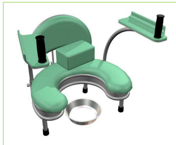
Figura 3.5 – Vista tridimensional da cadeira para parto de cócoras com encosto
