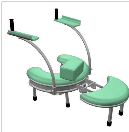
Figura 3.7 – Vista posterior tridimensional da cadeira com encosto deitado
