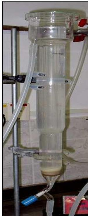
Figura III.1. Coluna de elutriação.
