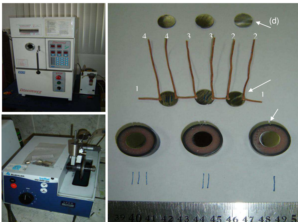
Figura 22. Sequência de produção e preparação dos discos finos de Ni-Ti. (a) Máquina de fusão Discovery All, (b) cortadeira metalográfica, (c) amostras após corte na cortadeira metalográfica. Amostras 1 – 55 % Ni (equiatômica), 2 – 54,85 % Ni e 3 – VIM 51.
