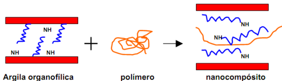
Figura 3: Processo de obtenção de nanocompósitos por fusão
