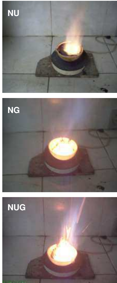
Figura 10 – Imagens das cores da chama durante a reação de combustão para as composições NU (uréia), NG (glicina) e NUG (uréia-glicina).
