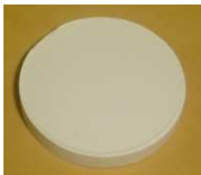
Figura 22 – Suporte cerâmico ( \alpha -alumina) sinterizado a 1200°C.
