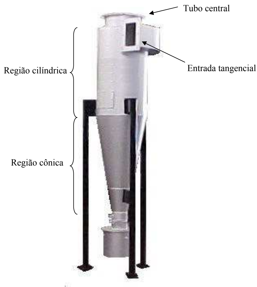
Figura 1 – Ciclone típico ( www.aalborg-industries.com.br/cps.htm )
